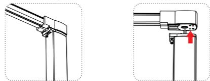
1.首先检查电机拨头锁杆是否在示意位置,如果在图示右侧,请先拉动拨头锁杆的同时拨向左侧。
