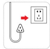
4.将电源线插在附近电源插座上,接通电源。
