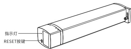
领普智能窗帘电机C1是一款Wi-Fi直连的智能窗帘开合帘电机,具备APP操控、智能音箱语音声控、自发电无线遥控、智能化联动功能,同时也支持手拉启动、停电手拉、遇阻停止等特性。
